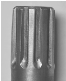
图 6 振动挤压成形的花键轴
